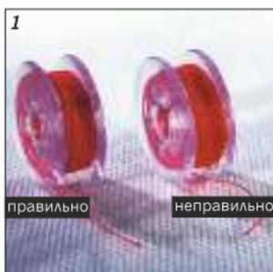
1. При намотке нижней нити используйте среднюю скорость вращения шпули и следите за тем, чтобы нить наматывалась на нее равномерно. Во время намотки старайтесь не изменять скорость намотки.
