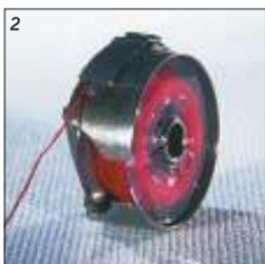
2. Устанавливайте шпулю в шпульный колпачок так, чтобы при сматывании нити она вращалась против часовой стрелки.
