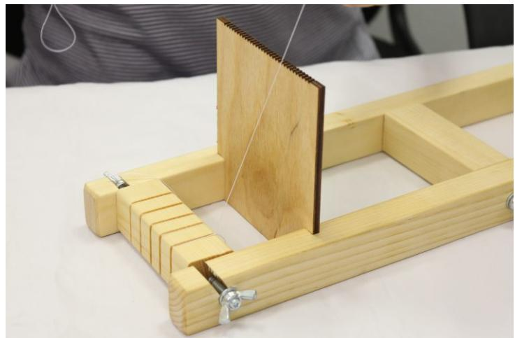
**3.** Протягиваем нить на противоположную сторону, располагаем на насечке на противоположной стороне станка, затем обматываем вокруг винта и снова протягиваем.
